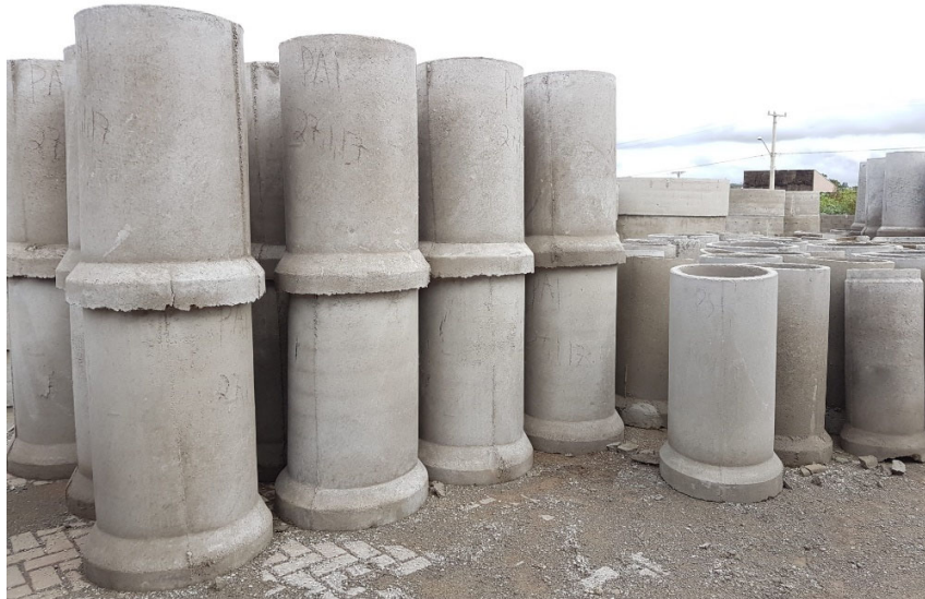
Figura 02 – Tubos de concreto classe PA1, encaixe ponta-bolsa
